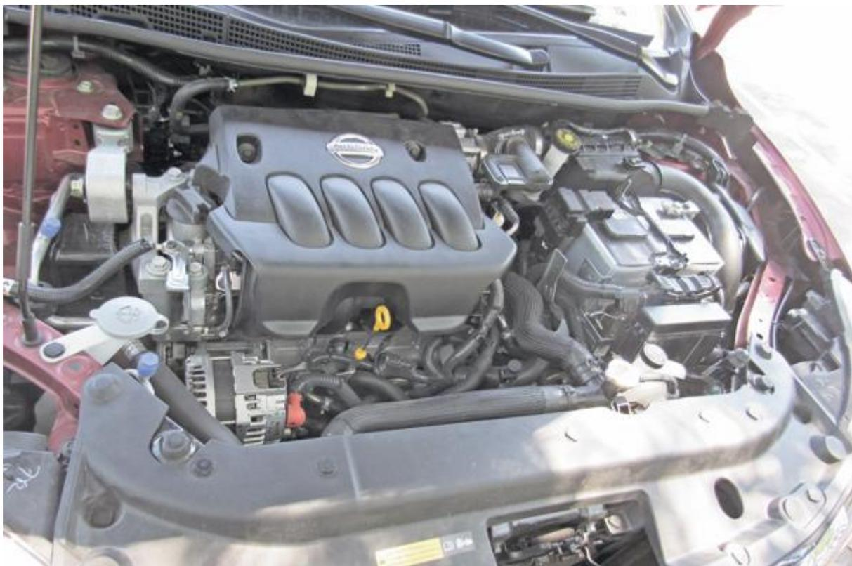
O propulsor MR20DE instalado sob o capô do Sentra foi lançado em 2005 e é um dos primeiros da série MR desenvolvidos pela Aliança Renault-Nissan – sob o código M4R, ele também é utilizado pelo Fluence. Ele substituiu o antigo QR20DE, projeto da montadora
